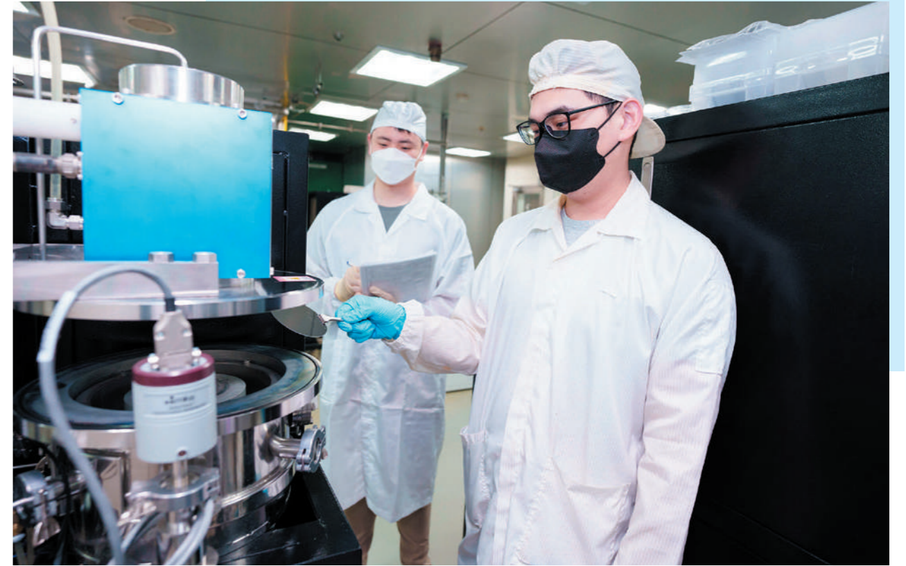
..... 長庚大學誘導耦合電漿系統 (ICP) 製程置入晶片進行蝕刻
